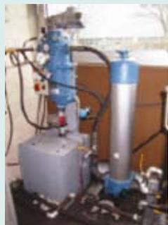
Filtre AF 173 sur bac de sédimentation avec filtre PI 230 et élément KS 25
