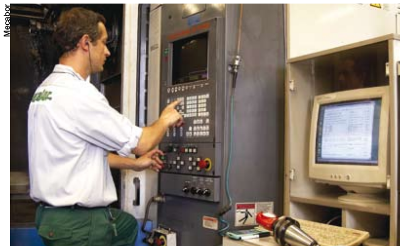
Tous les centres d'usinage sont couplés à des ordinateurs sur réseau permettant les transmissions de données
