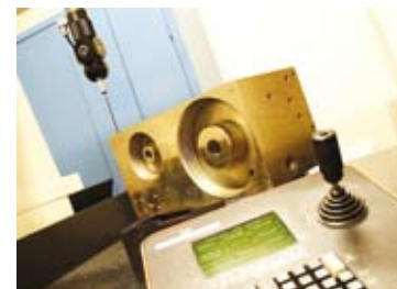
Le contrôle tridimensionnel permet le contrôle en automatique de la totalité des cotes d'un bloc
