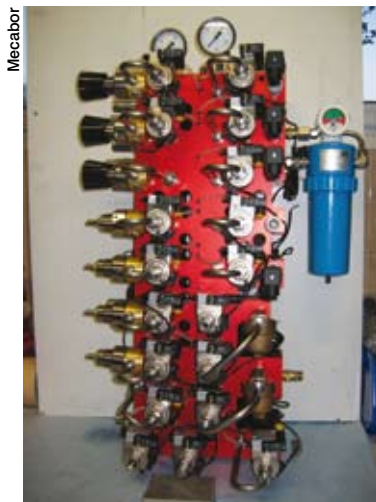
Bloc en aluminium anodisé rouge destiné à tester les circuits d'alimentation en carburant de l'Airbus A 380
