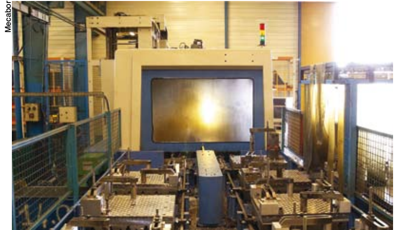
La majorité de la production est réalisée sur des centres d'usinage à commandes numériques
