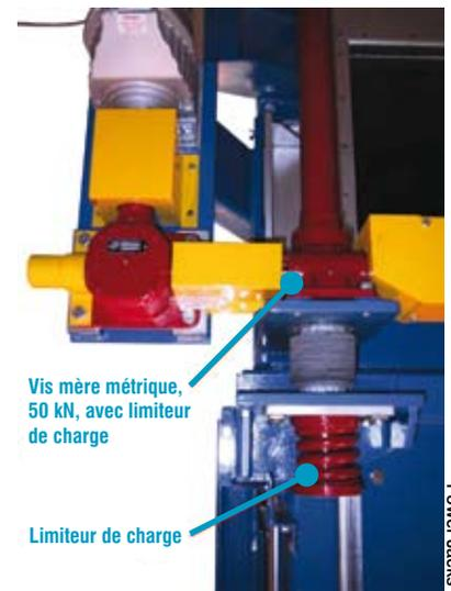
Vis mère métrique, 50 kN, avec limiteur de charge
