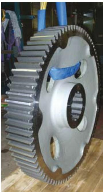
Roue d'élévation de plate-forme pétrolière taillée extérieurement : diamètre 1600 module 16, brochage de la denture intérieure
