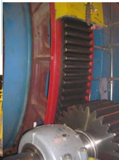
Rotary Breaker : tube tournant utilisé pour séparer le sable du schiste bitumineux dans l'Alberta, au Canada
