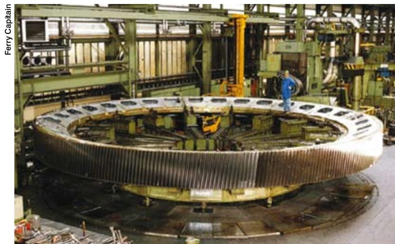
Taillage d'une couronne de 12 m sur une tailleuse à commande numérique au sein de l'usine allemande de Hattingen
