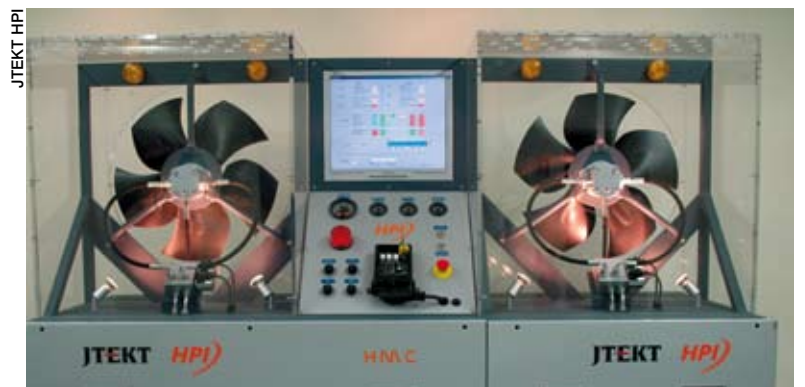
Banc d'essais du système HMC de régulation de la vitesse des ventilateurs utilisés pour le refroidissement des moteurs thermiques
