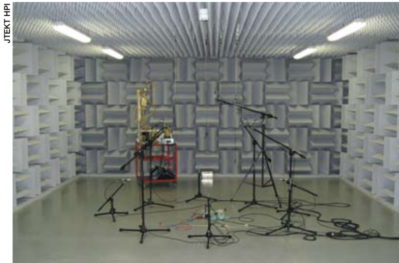
JTEKT HPI s'est doté de plusieurs chambres anéchoïques pour le test des composants et systèmes montés sur les engins des clients constructeurs.
