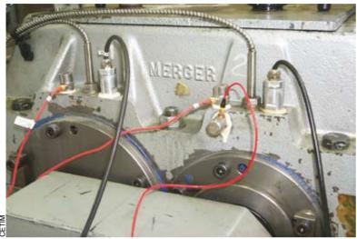
Banc d'essais de surveillance acoustique/vibratoire des éléments de la chaîne cinématique
