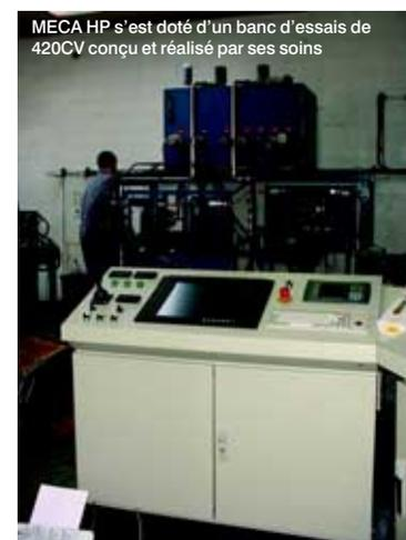
MECA HP s'est doté d'un banc d'essais de 420CV conçu et réalisé par ses soins
