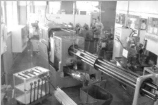
Cellule d'usinage de clapets
