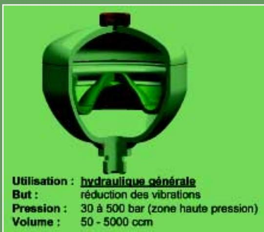
« Chaque type d'accumulateur possède sa propre pression de fonctionnement et une capacité de volume », explique le docteur Käsler. « Utilisés en amortisseurs, ils régulent les flux en volume et en pression. La limitation des décibels dépend de l'amplitude entrée/sortie, qui change selon la fréquence de la pression. L'amortissement nécessite donc une optimisation ». Simrit produit trois types d'ac-
