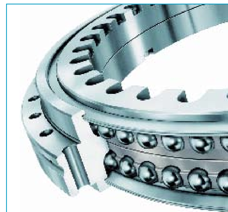
Pour le montage précis et rigide d'une table tournante à haute vitesse : butées à billes à contacts obliques INA de la série ZKLDF.
