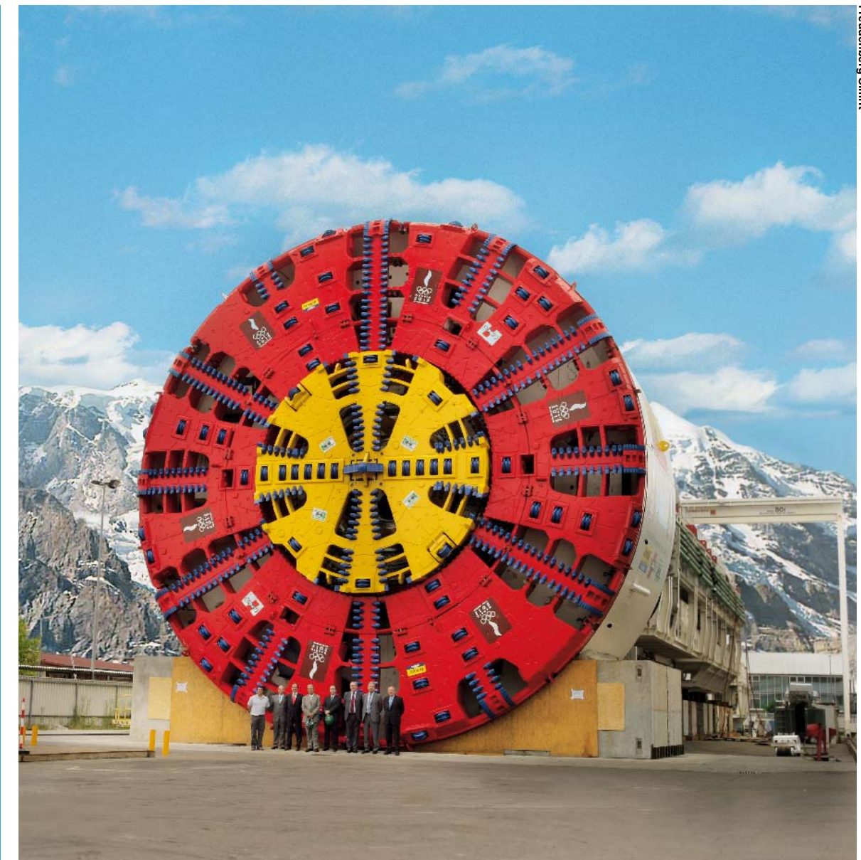
Herrenknecht AG a développé spécialement un nouveau concept de tête de coupe : deux disques concentriques peuvent tourner indépendamment l'un de l'autre et dans les deux sens.
