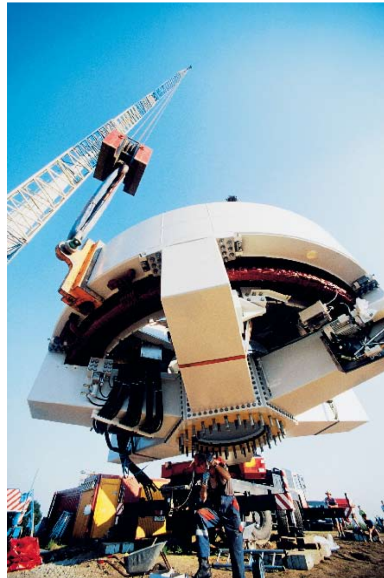
Des procédés spéciaux de collage par vulcanisation permettent le montage des bagues directement sur site.
