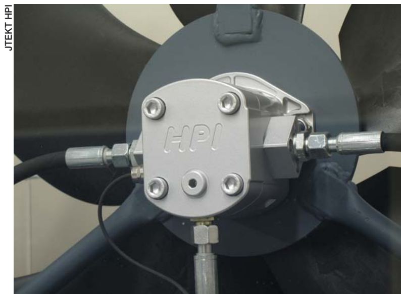
JTEKT HPI a développé la solution d'aéro-refroidissement HMC constituée de capteurs reliés à une carte électronique qui transmet des informations au moteur hydraulique, permettant ainsi de réguler très précisément les besoins de refroidissement du moteur
