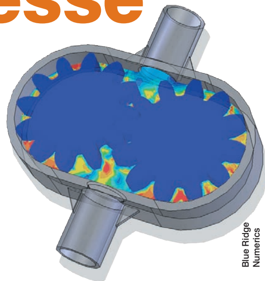
Cette simulation de pompe à engrenages montre le mouvement de fluide spécifique généré par la rotation de chaque engrenage. Le mouvement a été calculé par CFdesign en moins de 5 minutes !
