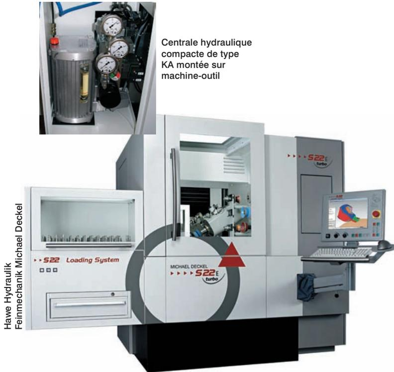
Centrale hydraulique compacte de type KA montée sur machine-outil
