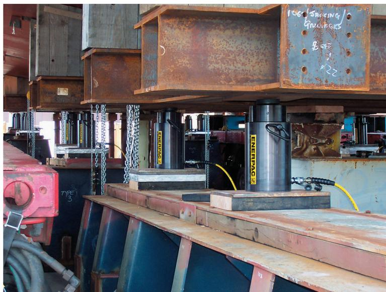
Ce système de levage synchronisé a été équipé de seize vérins hydrauliques en aluminium simple effet avec écrou de sécurité de type RACL-150. Chaque vérin a une capacité de levage de 150 tonnes pour une pression de travail maximum de 700 bar sur une course de 150 millimètres.
