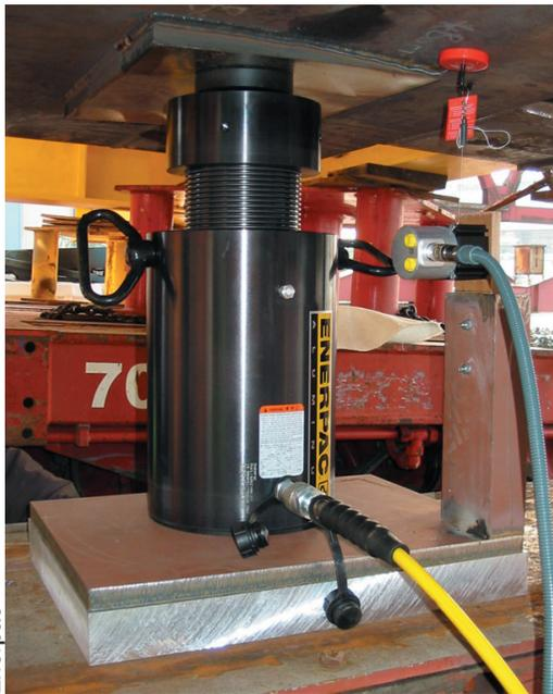
Vérin hydraulique RACL-1506. L'écrou de sécurité permet le maintien mécanique de la charge pendant des périodes prolongées.
