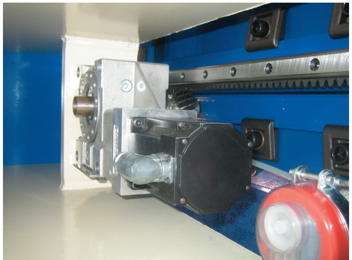
Plusieurs produits Atlanta sont montés sur cette machine de découpe par jet d'eau : réducteur roue et vis de précision 58 ; pignon fendu avec système mécanique de rattrapage de jeu ; crémaillère traitée après taillage ; système automatisé de lubrification.
