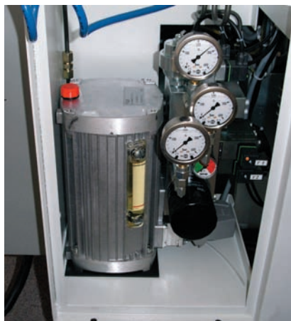
Centrale hydraulique compacte Hawe Hydraulik montée sur machine-outil
