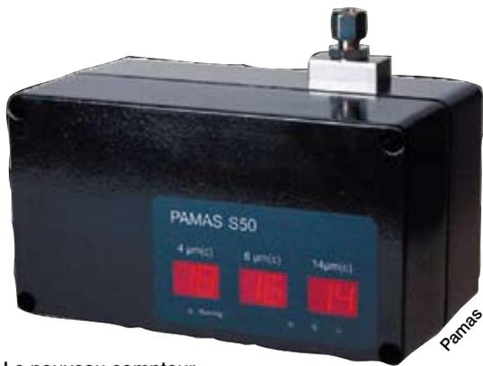
Le nouveau compteur en ligne S50 présente la particularité de travailler sous pression en fonction du débit réel calculé par la cellule
