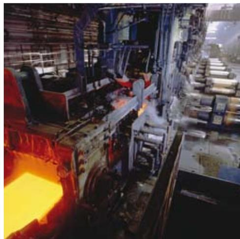
Dans les coulées continues, les rouleaux supportent la coulée de l'acier durant tout le process. Afin de limiter les flexions, les rouleaux sont supportés sur leur longueur par plusieurs roulements exposés à de fortes charges, à de faibles vitesses, aux projections d'eau et à des températures élevées. Les facteurs d'influence essentiels sont le type et la qualité des garnitures d'étanchéité.
