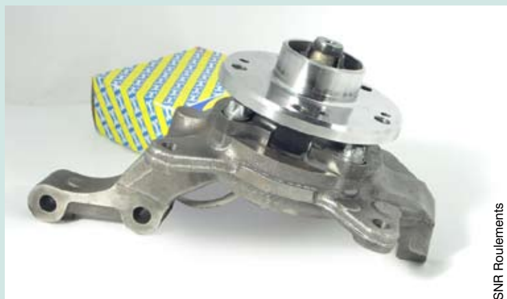
Cette troisième génération de roulement instrumenté ASB mesure les efforts mécaniques qu'il subit, tout en restant dans l'encombrement normal d'un roulement de roue d'automobile.
