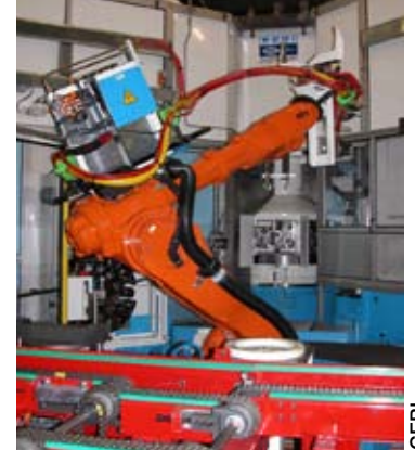
Amenées par chariots à guidage laser, les pièces brutes sont chargées par deux robots ABB.
