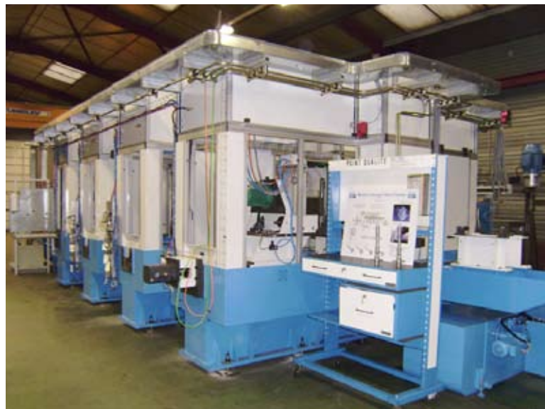
CERI va livrer une ligne transfert d'usinage d'arbres de boîtes de vitesses automatiques pour le compte d'un constructeur automobile américain.
