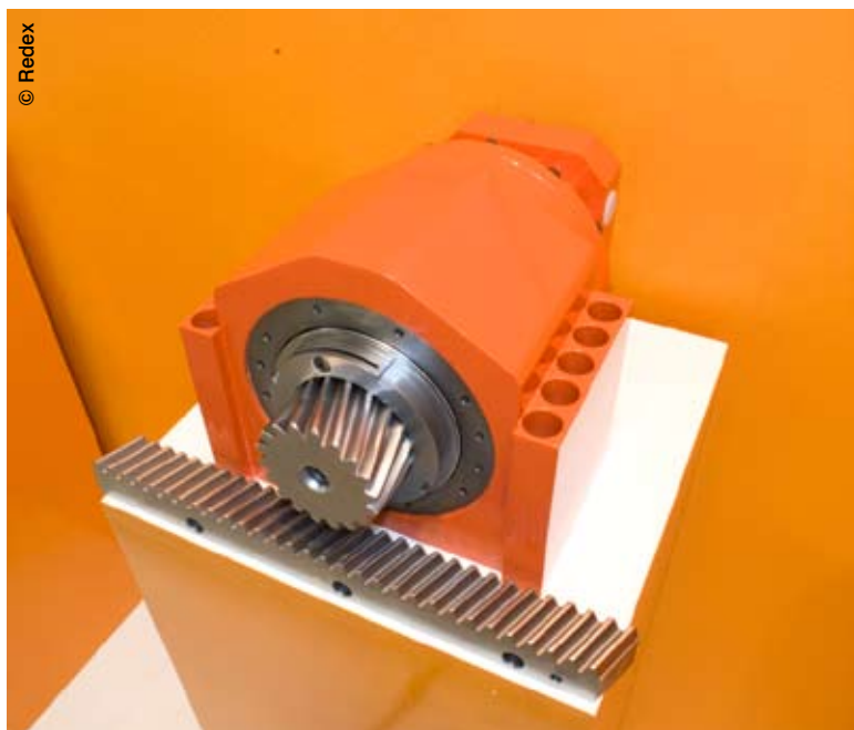
Le KRPX a été présenté à l'EMO 2009 de Milan. Il s'agit d'une version spéciale du KRP permettant une intégration simple et une très grande raideur
