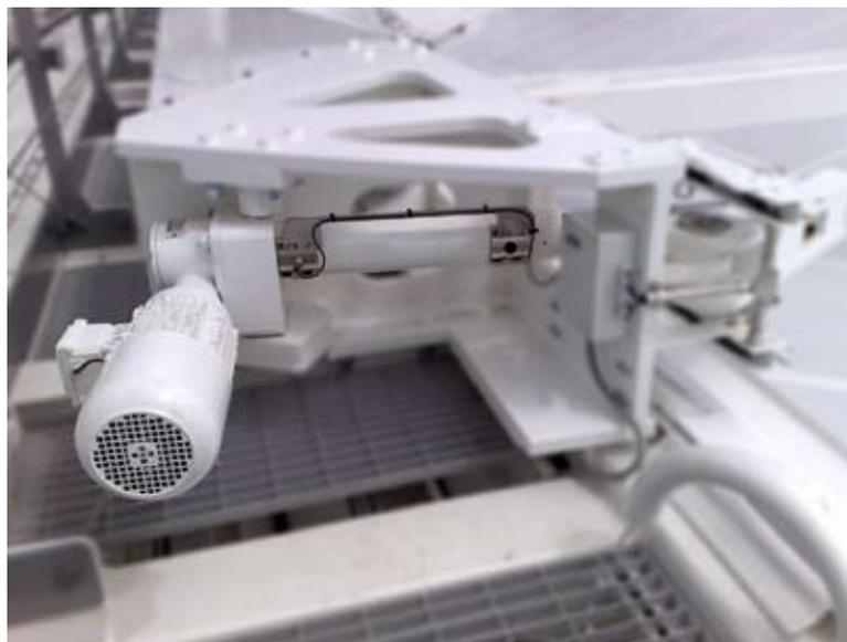
Actionneur Rolaram bloquant les segments de toit
