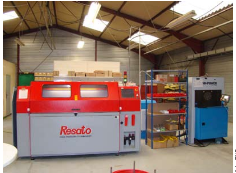
Banc d'essais Resato pour la réalisation de tests à l'eau jusqu'à 4.000 bar et au glycol pour des pressions de 4.000 à 7.000 bar.
