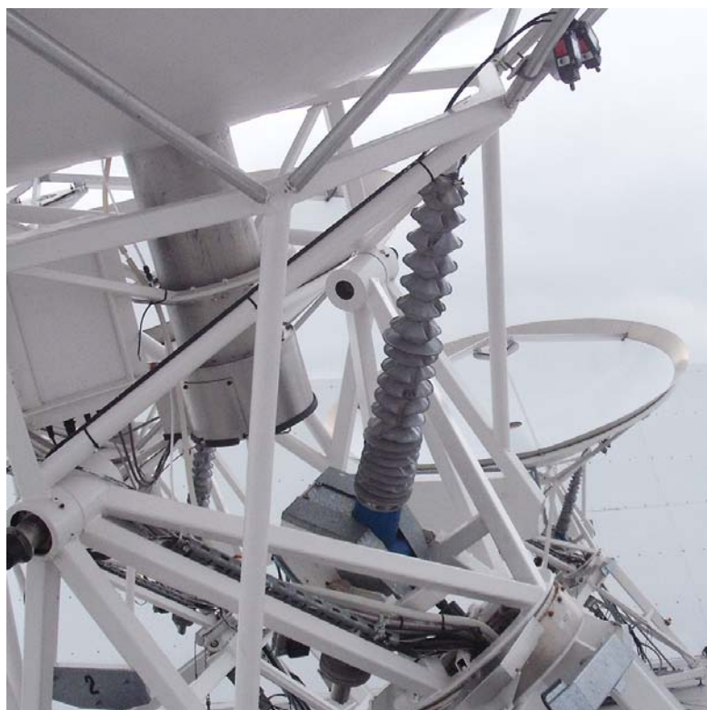
Vérin à vis de pilotage de l'antenne
