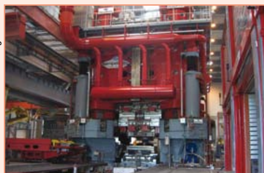
La presse à matricer de 40 000 tonnes de la société de fabrication de pièces pour l'aéronautique Airforge.
