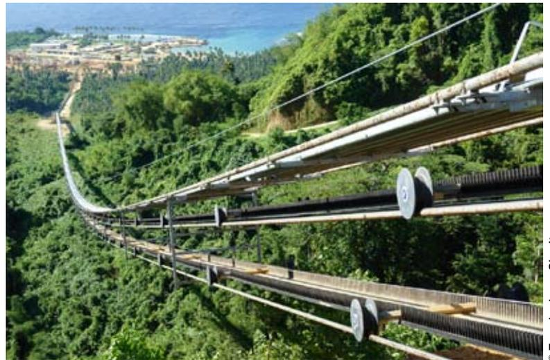
Les convoyeurs à câbles pour le transport de matières en vrac exigent des dispositifs d'étanchéité spéciaux pour les paliers de roues de roulement.
