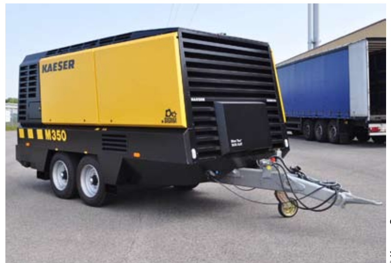
Kaesar Compresseurs équipe ses compresseurs d'un SCR (Réduction Catalytique Sélective) en y installant un convertisseur catalytique lié à l'additif AdBlue.
