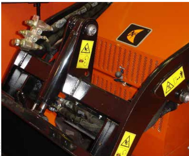
Les systèmes hydrauliques des engins mobiles étant de plus en plus compacts, la place laissée aux connexions hydrauliques se réduit. D'où l'intérêt des raccords rapides ne nécessitant pas l'utilisation d'outillage à main.
