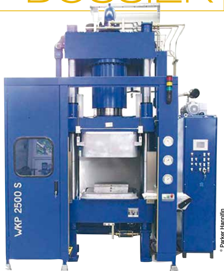
Des tests effectués sur un système de presse hydraulique ont montré qu'en utilisant des variateurs Parker SSD, une puissance moyenne de seulement 25 kW suffisait contre 38 kW avec une pompe non régulée.
