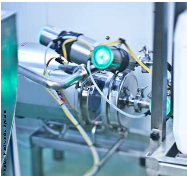
Bürkert a réalisé des blocs de vannes spécifiques permettant de réduire au maximum les zones de rétention propices au développement bactériologique.
