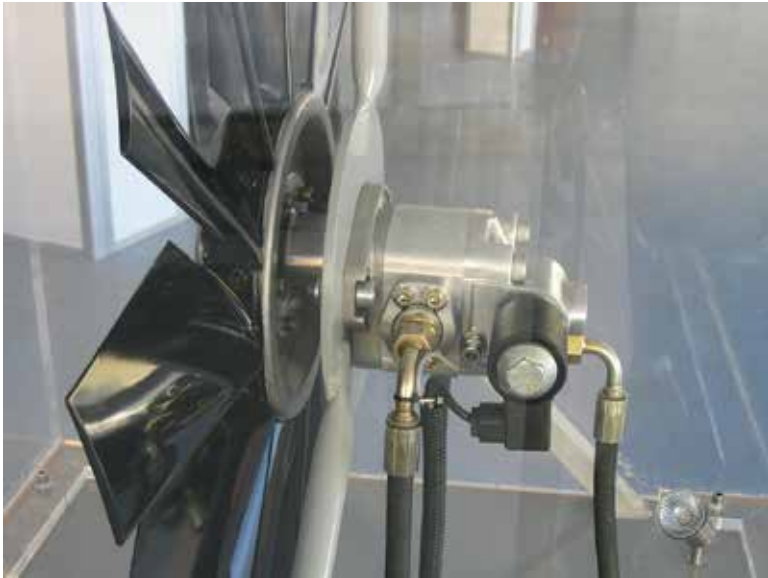
Entraînement hydrostatique de ventilateur JETKT HPI destiné au refroidissement de moteurs thermiques.
