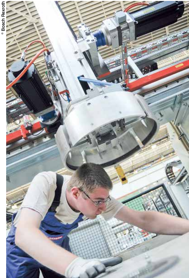
Le système de freinage et d'arrêt sûr de Bosch Rexroth empêche la chute des axes verticaux, même en cas de coupure secteur.
