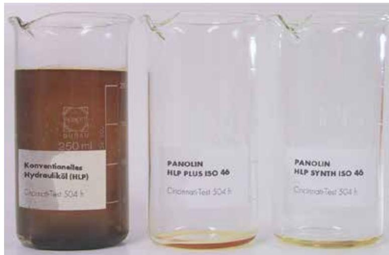
Test d'oxydation Cincinnati.
