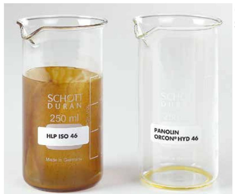
Éprouvette de gauche : résidu solide après test d'oxydation ASDM
