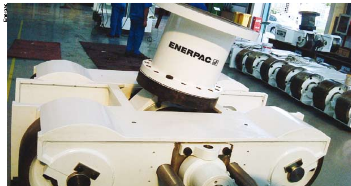
Les vérins hydrauliques compensent les oscillations horizontales des chariots et évitent les sorties de rail.
