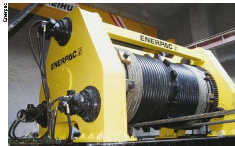
Pour l'ouverture et la fermeture, 8 treuils hydrauliques font rouler la toiture mobile sur des rails.
