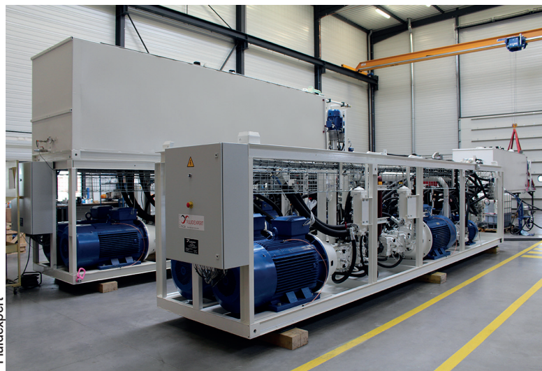
L'atelier de Fragnes abrite actuellement les skids hydrauliques destinés aux tunnels NFM qui seront utilisés pour la réalisation du métro de Sao Paulo, au Brésil
