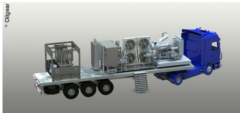
Produit breveté, la Transfer Barrier® est une pompe à motorisation fluide effectuée par une centrale hydraulique huile servo-contrôlée. Son utilisation se traduit par une réduction de la puissance consommée allant jusqu'à 15% par rapport à une pompe Triplex.
