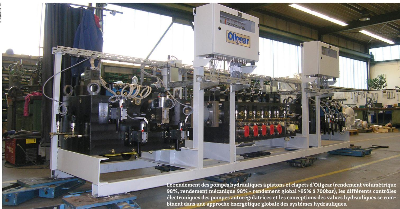
Le rendement des pompes hydrauliques à pistons et clapets d'Oilgear (rendement volumétrique 98%, rendement mécanique 98% - rendement global >95% à 700bar), les différents contrôles électroniques des pompes autorégulatrices et les conceptions des valves hydrauliques se combinent dans une approche énergétique globale des systèmes hydrauliques.
