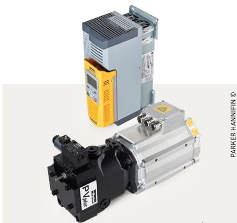
La pompe à entraînement contrôlé DCP (Drive Controlled Pump) de Parker Hannifin, combinaison d'une pompe optimisée à pistons axiaux et d'un servomoteur synchrone très compact, offre des avantages décisifs par rapport aux systèmes de pompes à vitesse variable courantes et « permet d'économiser jusqu'à 70% d'énergie par rapport aux solutions d'entraînement traditionnelles ».
