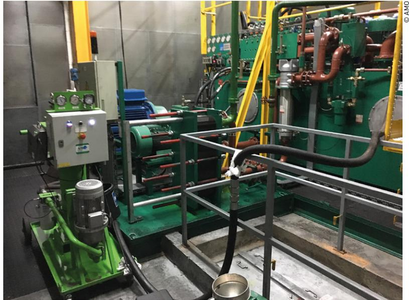
Dépollution d'une charge de 5m<sup>3</sup> dans une centrale hydraulique de laminoir, après un test MPC (vernis et précurseur de vernis) trop élevé. Passage de 33 à 10 après 2 mois de traitement avec filtre 0,9µ.
