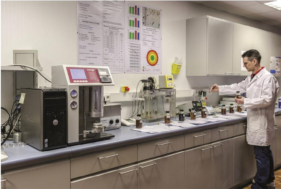
Plusieurs milliers d'analyses de fluides sont réalisées chaque année au sein du laboratoire de Saint-Ouen-l'Aumône d'HYD&AU FLUID, doté d'outils permettant de contrôler le vieillissement physico-chimique de l'huile.
