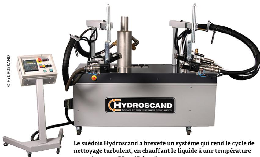
Le suédois Hydroscand a breveté un système qui rend le cycle de nettoyage turbulent, en chauffant le liquide à une température comprise entre 55 et 65 degrés.
