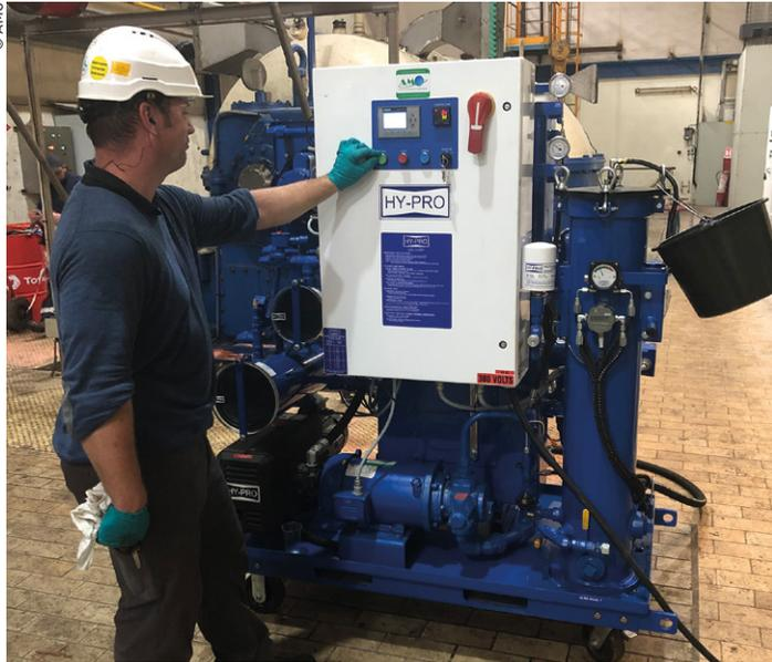
Le premier critère à considérer dans la gestion des fluides est la classe de propreté. Ici, dépollution d'une charge de turbo alternateur 5m<sup>3</sup> suite à la présence de particules et d'eau.
