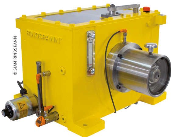
Le groupe Siam Ringspann fournit des roues libres sous carter FH équipées de capteurs de vibration et de vitesse et des sondes de température reliés à une électronique de diagnostic pour la maintenance prédictive.
