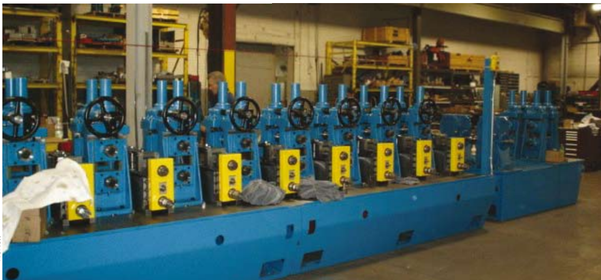
Vérins : fabrication de tube acier
