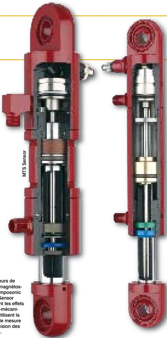
Les capteurs de position magnéto-sonotricifs Tempsonic de MTS Sensor combinent les effets magnéto-mécaniques et utilisent la rapidité de mesure et la précision des ultrasons.
