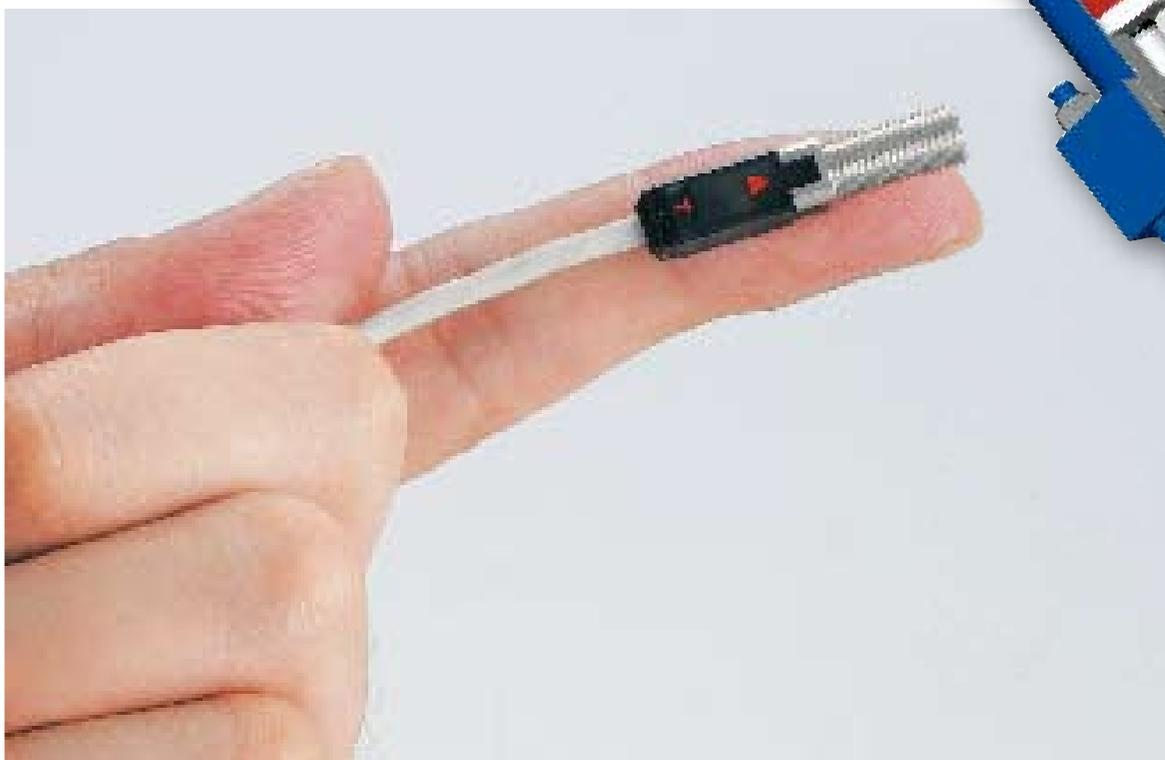
Le capteur sans contact SF1 équipe le vérin standard type OCT de Bosch-Rexroth (Iso 6432). Constitué d'une partie sensible (un capteur à film) et d'une électronique de sauvegarde des informations, un unique module permet de programmer jusqu'à 4 positions. Le capteur à film est un capteur magnétique de distance qui fournit en permanence une sortie analogique proportionnelle à la distance mesurée.
