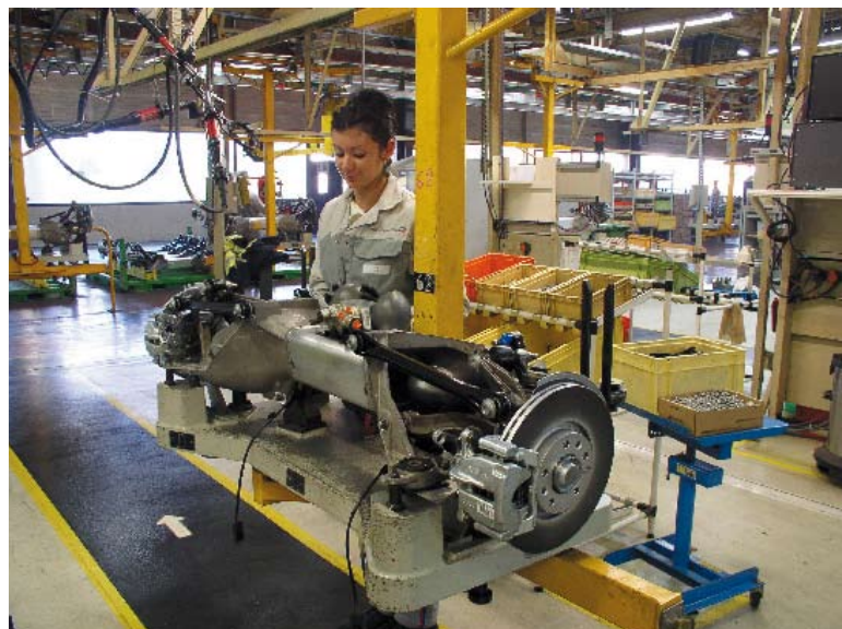
Montage de trains arrière pour la Citroën C6 (Montage essieu)
