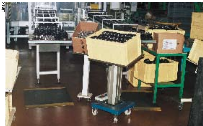
Les servantes d'atelier s'adaptent aux postes debout et assis. La mise à hauteur est assurée par une colonne LP2 alimentée par batterie. L'inclinaison du plateau favorise la prise des pièces par l'opérateur
