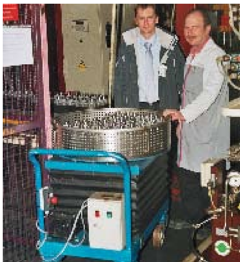
Mise en service du chariot avec panier tournant par Yvan Lavaux et Thierry Menant (à droite). Ce chariot est très maniable et peu encombrant. La rotation du panier et le réglage de la hauteur diminuent les postures inconfortables.
