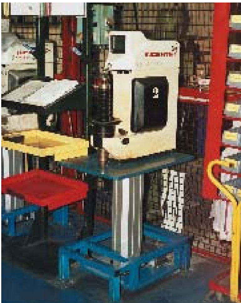
Poste de contrôle de dureté diminuant considérablement la charge physique des opérateurs. Le plan de travail avec gestion de la hauteur supprime les postures défavorables
