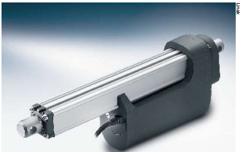
Le vérin linéaire LA36 (course de 1000 mm) fournit une force atteignant jusqu'à 6800 N en compression ou en traction
