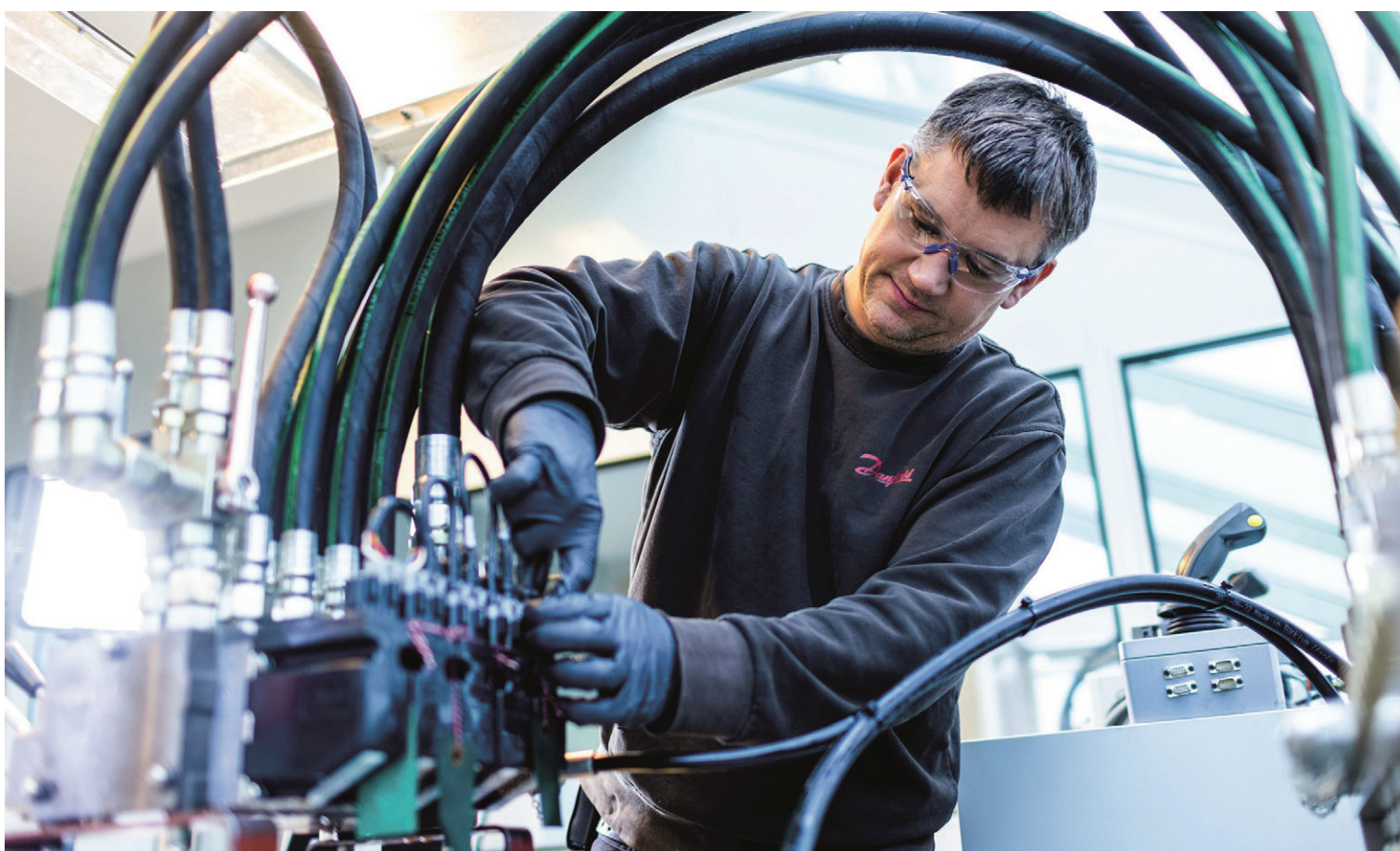
Test du flexible tressé, en lieu et place du traditionnel tuyau spiralé.
