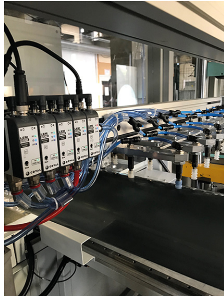
Le système ASC (air saving control) intervient pour stopper la consommation d'air comprimé dès que le niveau de vide est atteint, évitant toute consommation inutile.
