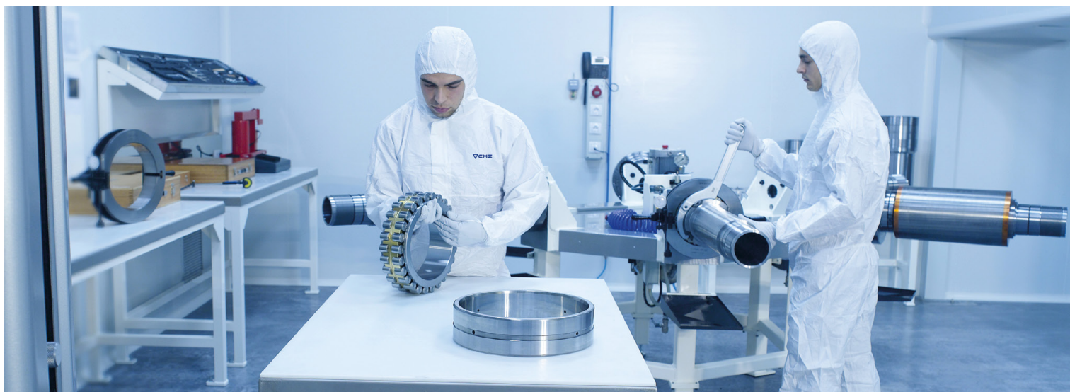
Roulements à rouleaux cylindriques à double rangée NSK préparés pour être montés sur les broches des tours CMZ dans des conditions de salle blanche.
