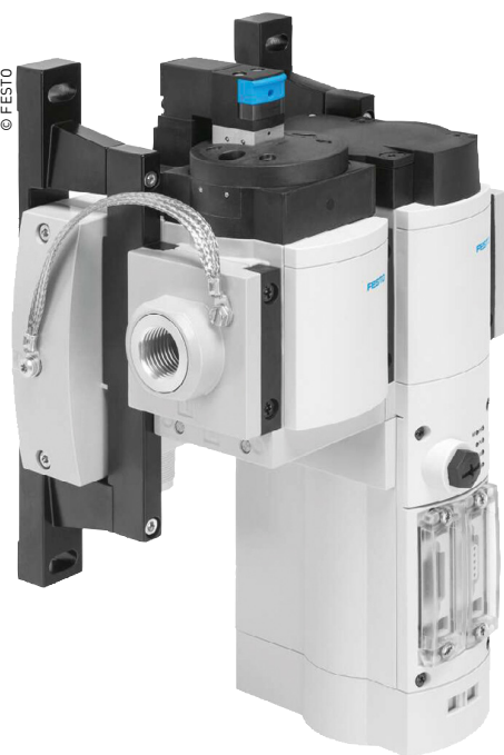
Les MSE6-E2M de Festo détectent les phases d'arrêt de la machine et coupent leur arrivée d'air pour stopper la consommation sur ces phases de stand-by.
