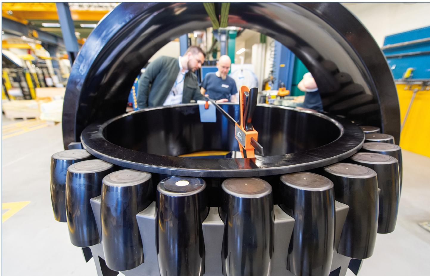
Le système de monitoring Sensor Roller de SKF permet d'anticiper une panne mécanique sur les roulements. © SKF
